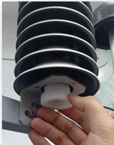
รูปที่ ๓๕ ตัวล็อกเครื่องวัดที่ติดอยู่กับอุปกรณ์ป้องกันรังสีจากดวงอาทิตย์
