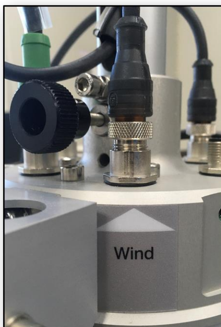
รูปที่ ๔๓ การต่อสายสัญญาณเครื่องวัดทิศทางและความเร็วลม เข้ากับชุดอุปกรณ์ประมวลผล
