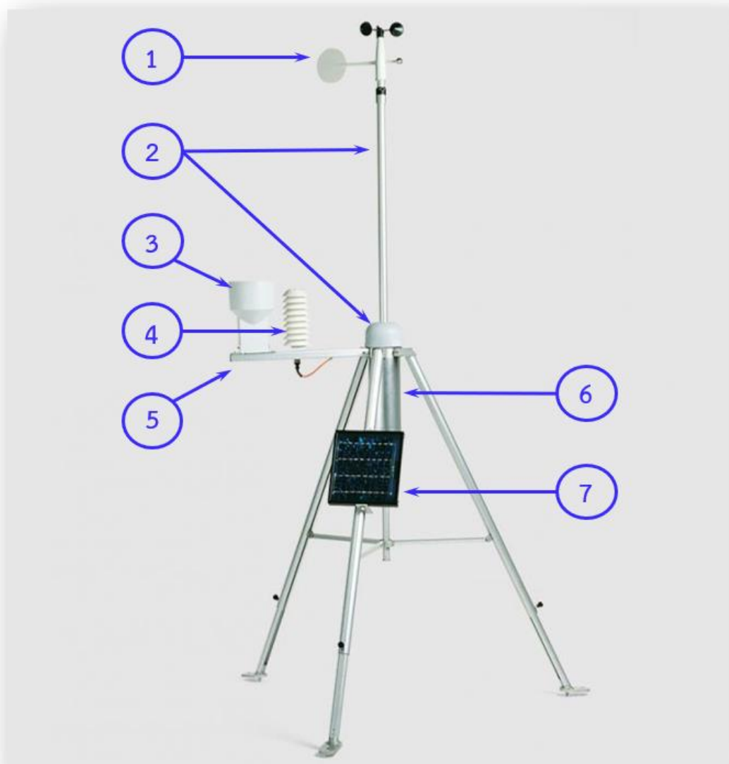
รูปที่ ๒ ส่วนประกอบของสถานีตรวจอากาศอัตโนมัติ (MAWS201)
