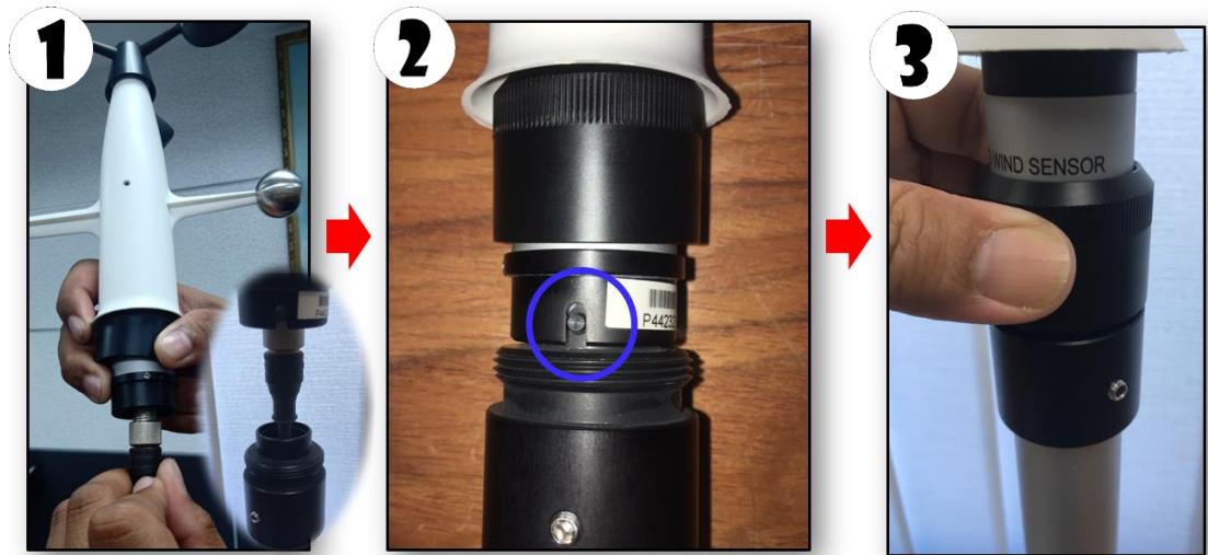
รูปที่ ๔๑ การประกอบเครื่องวัดทิศทางและความเร็วลมเข้ากับเสาเครื่องวัด
