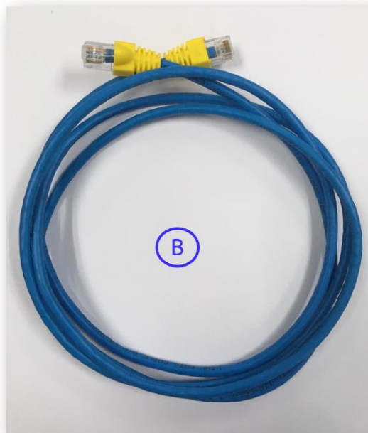
รูปที่ ๒๓ สายอินเทอร์เน็ต (LAN) พร้อมหัวต่อ (RJ-45) ความยาว ๒ เมตร
