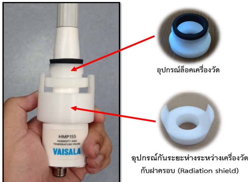
รูปที่ ๓๖ อุปกรณ์ล็อคเครื่องวัด และอุปกรณ์กันระยะห่าง ที่สวมเข้าไปที่เครื่องวัดอุณหภูมิและความชื้นสัมพัทธ์
